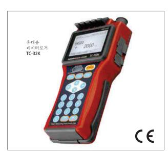
TC-32K는 한 손에 깔끔하게 들어가는 컴팩트한 모양의 휴대형 측정기입니다. 방적 구조로 야외에서도 안심하고 사용할 수 있습니다. 센서를 접속하는 단자부는 리드선, 바나나 플러그로 간단하게 접속 가능한 원터치 타입(특허)을 사용하여 빠르게 측정할 수 있습니다. 최대 20채널의 센서 모드, 계수, 이니셜 값 설정 및 측정 데이터 기록이 가능하며 여러 현장을 이동하면서 데이터를 수집하는 경우 등에서도 데이터 정리가 용이합니다. 또한 전용 스위치 박스 CSW-58를 사용하여 5점의 자동계측이 가능합니다. 인터별 타이머, 데이터 메모리, CF카드에 의한 기록과 PC와 접속하여 컨트롤 및 데이터 전송도 실시할 수 있습니다. 저항 및 절연 저항 체크 기능을 통해 스트레인게이지 및 변환기 등의 체크에도 사용할 수 있습니다.
