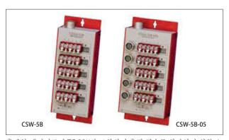
휴대형 데이터로거 TC-32K와 조합하여 측정 점수를 확장하기 위한 스 위칭박스입니다. 측정 점수는 5점으로 변형, 직류 전압, 열전대, 백금측 온저항체를 모두 측정할 수 있습니다
